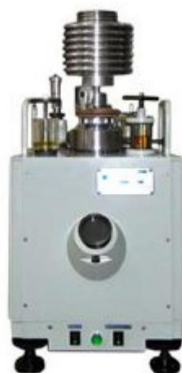
2.13 - сурет– МПАК-14 типті абсолютті қысым манометрі
